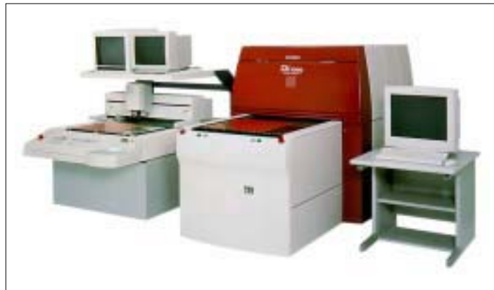
ドリル穴検査装置DI-1000、 および目視確認ステーションVT-1020のセット
