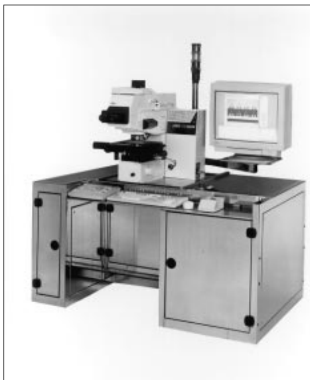
解像度0.2マイクロメートルを実現した マスク線幅測定装置「Leica LWM250UV」
